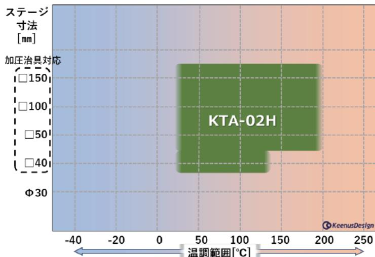
溫控Stage的部件和結構因溫度控制表面尺寸大小和控制溫度帶的組合而會有所不同。
