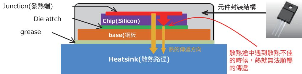
半導體元件的內部是由各種不同材料所構成的封裝結構，依據熱傳遞的困難度會有熱阻的產生，所以量測出封裝結構當中熱阻偏高的位置點是很重要的。
