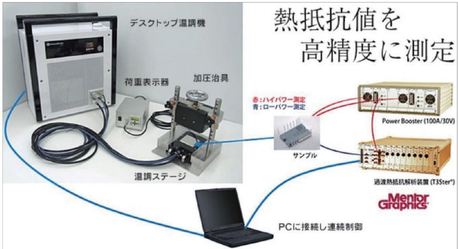
此套溫控平台設備，除了單獨進行控溫使用之外，也可以和西門子硬體產品T3Ster暫態熱阻量測儀無縫接軌的搭配使用，進行高精度的熱阻量測。
