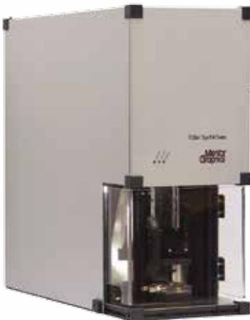
基於使用材料厚度及熱阻變化的對應關係來當做基準來進行導熱係數的測試，這樣的測試方式是符合 ASTM D5470 規範標準的測試法。溫度的量測是透過裝置在機台上半部的二極體進行，在精準的溫度量測 (解析度 0.01°C) 以及配合輸入電流所產生的功率計算之下可以得到具有高再現性的量測結果。
