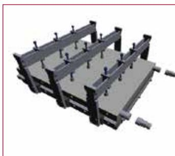
大型夾製具含Julabo冰水機 (散熱瓦數:500W)
